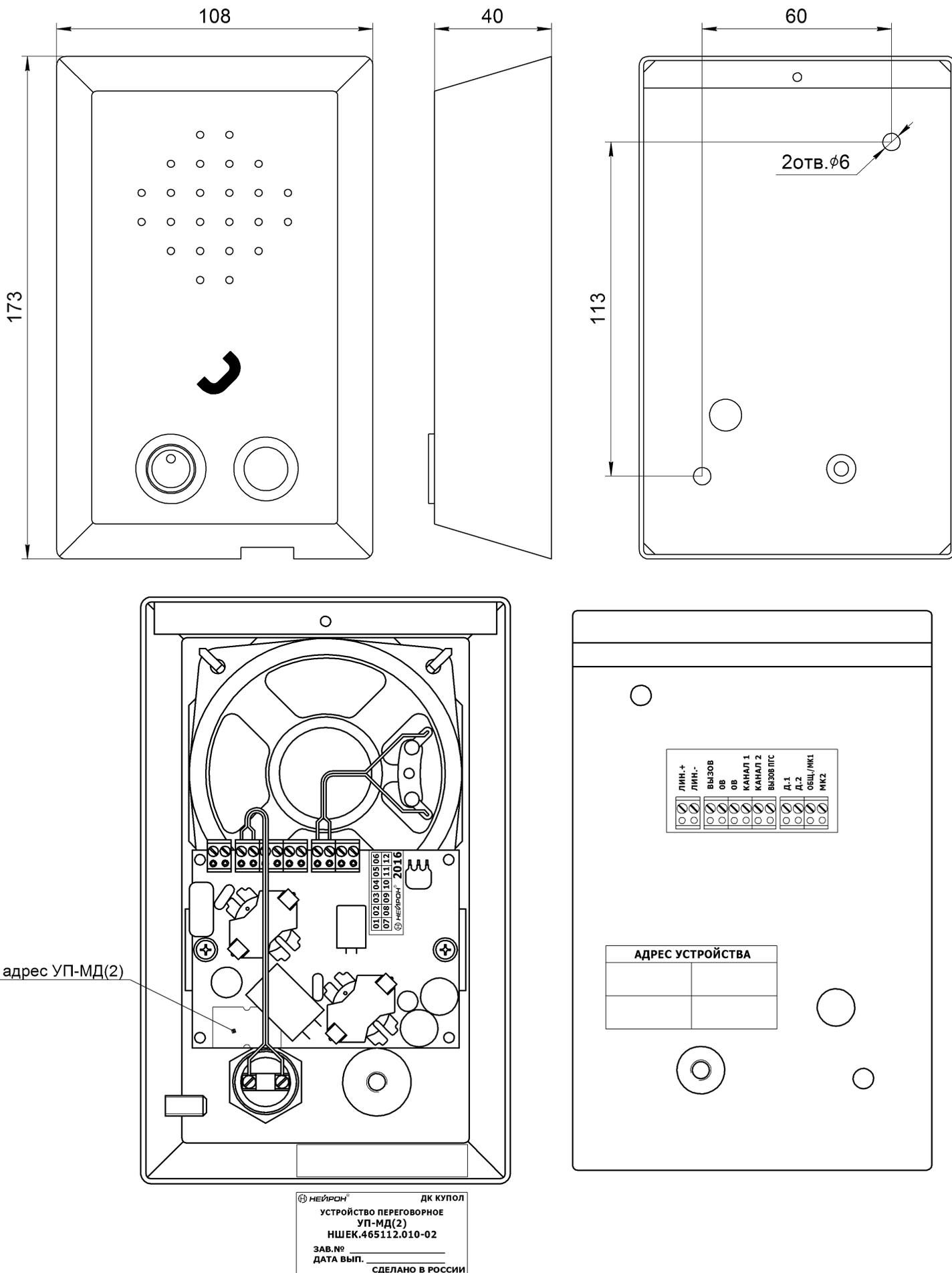
Рис.1 - Внешний вид Устройства переговорного УП-МД(2) НШЕК.465112.010-02
